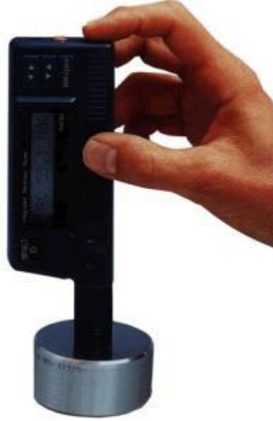
Şekil 7. Shore Sertlik Ölçme Deneyi.
