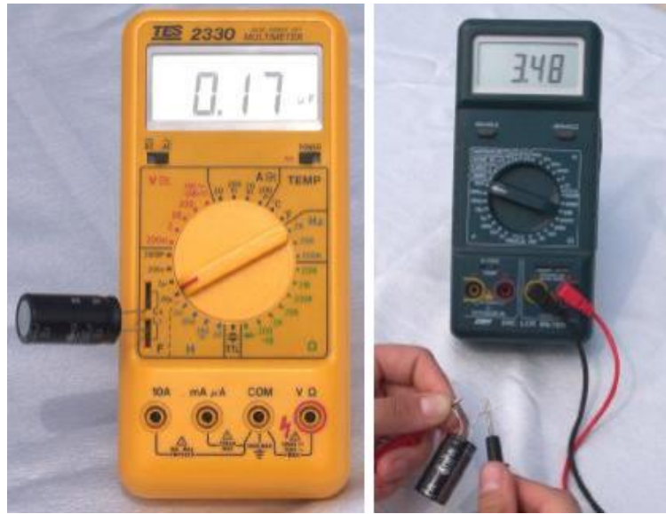
Şekil 13. Avometre ve LCR metre ile kapasite ölçme.
